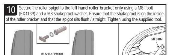
MUST SIT INSIDE THE BRACKET AGAINST THE T-BOLT HEAD
