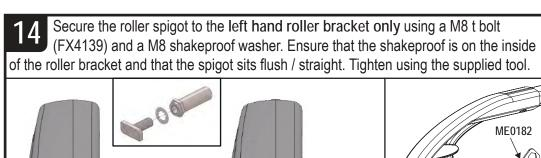
M8 SHAKEPROOF MUST SIT INSIDE THE BRACKET AGAINST THE T-BOLT HEAD
